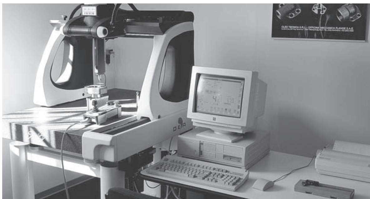
APPARECCHIATURA DI MISURA TRIDIMENSIONALE A C.N. (SALA METROLOGICA)
